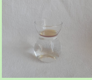
Şekil 16. Yoğunluk Farkından Dolayı Üstte Kekik Suyunun Üzerinde Toplanmış Olan Kekik Uçucu Yağı
