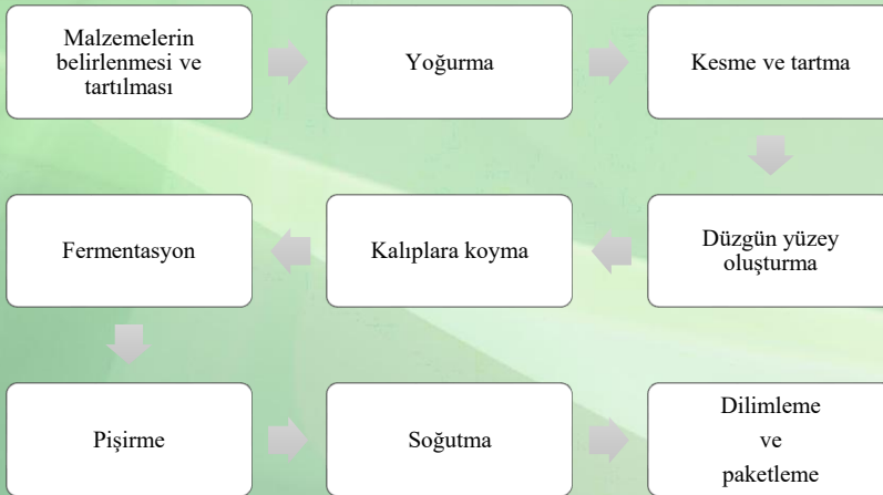
Şekil 4.20. Tost ekmeğinin üretim akım şeması.
