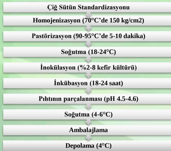
Şekil 2. Endüstriyel kefir üretiminin akım şeması
