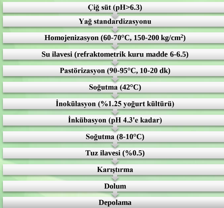
Şekil 4. Ayran Üretimi Akış Şeması
